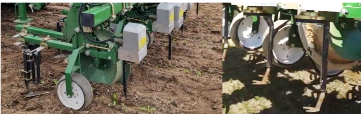
Abbildung 14: Testeinsatz des InRow Weeder während des Arbeitens (links) und die Hackwerkzeuge (rechts)
